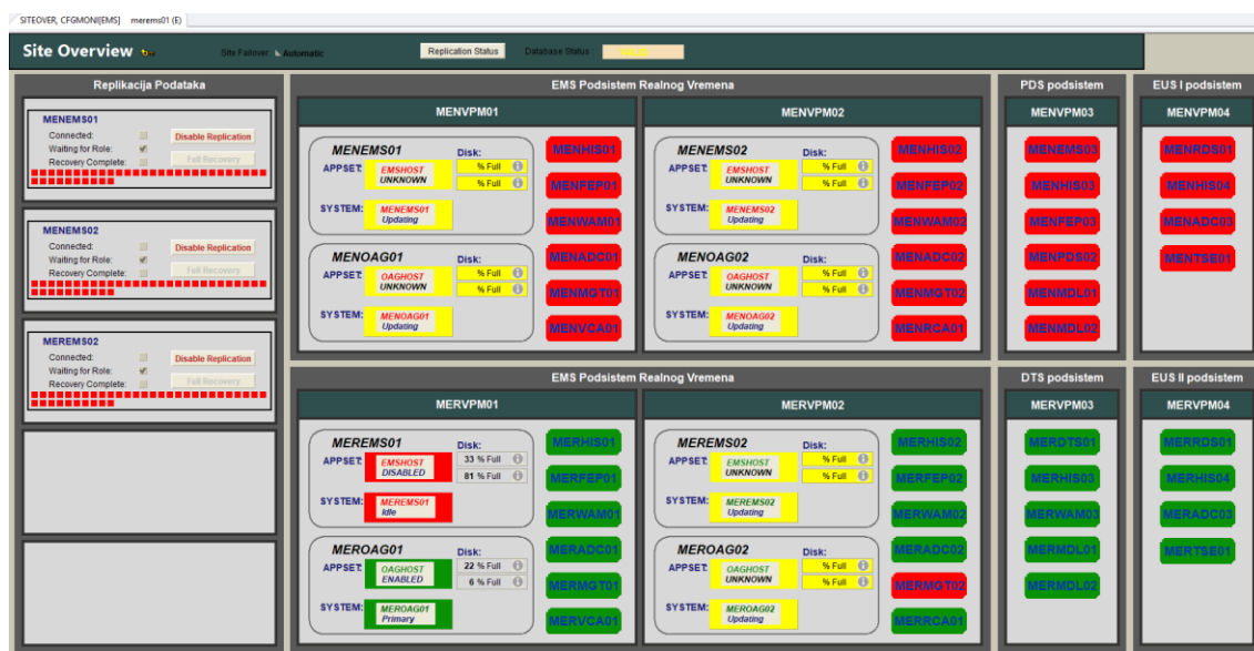
Slika 6: Stanje ahitekture sistema nakon vraćanja MERVPM02 fizičkog servera u pogon.
